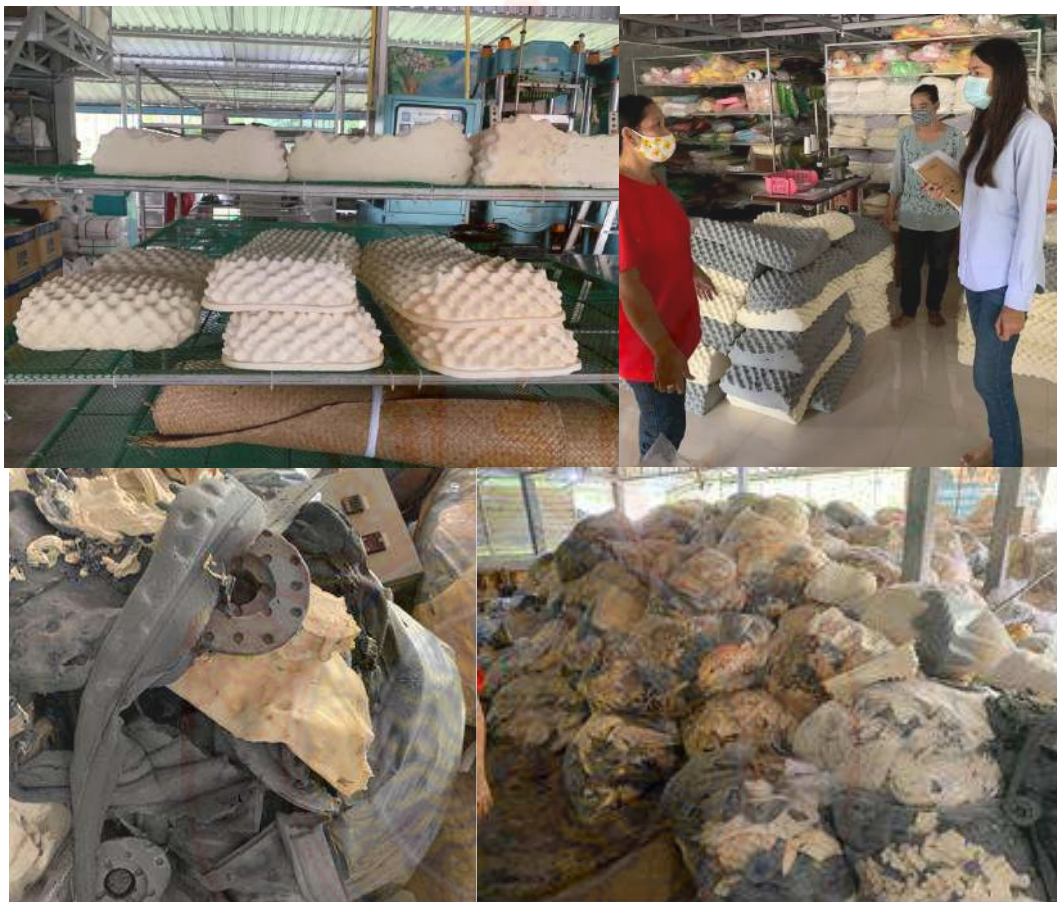
ภาพที่ 82 หมอนยางพาราที่รอการตัดเศษยางออก
