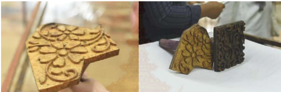
ภาพที่ 11 แม่พิมพ์เทียนแบบที่ทำขึ้นจากแผ่นไม้ แหล่งที่มา: สัมภาษณ์ (วสันต์ เส็งเสียม, 2563)
