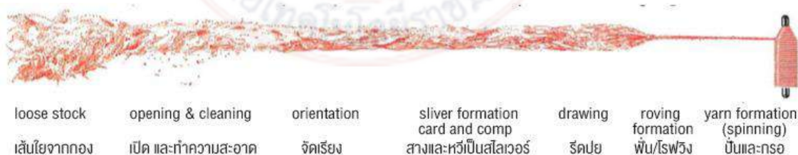
ภาพที่ 24 ภาพกระบวนการปั่นเส้นใยเป็นเส้นด้าย
