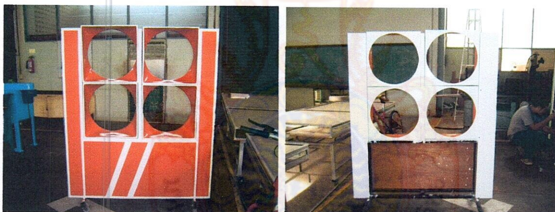
ภาพที่ 3.13 กำแพงและอุโมงค์ลมที่ประกอบแล้ว
