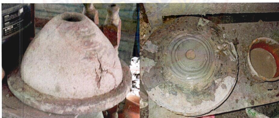
ภาพที่ 35 เป็นหมุน (มอน) สำหรับขึ้นรูปผลิตภัณฑ์ในอดีตและเป็นหมุนไฟฟ้า
