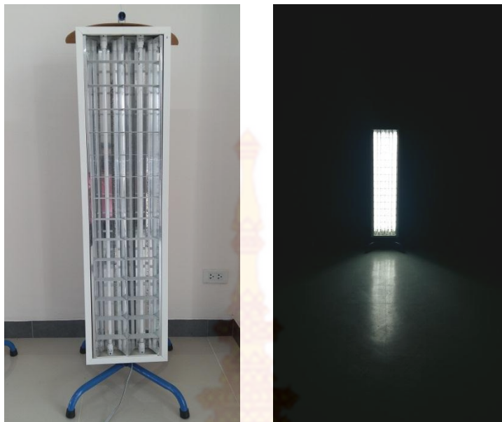
ภาพที่ 28 โคมไฟทดสอบหลอดฟลูออเรสเซนต์ชนิด T5
