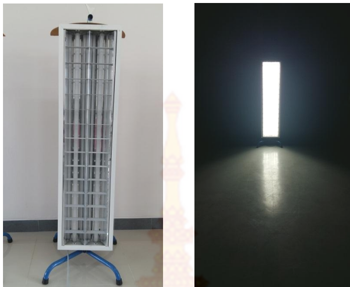
ภาพที่ 25 โคมไฟทดสอบหลอดฟลูออเรสเซนต์ชนิด T8 แบบบัลลาสต์แกนเหล็ก
