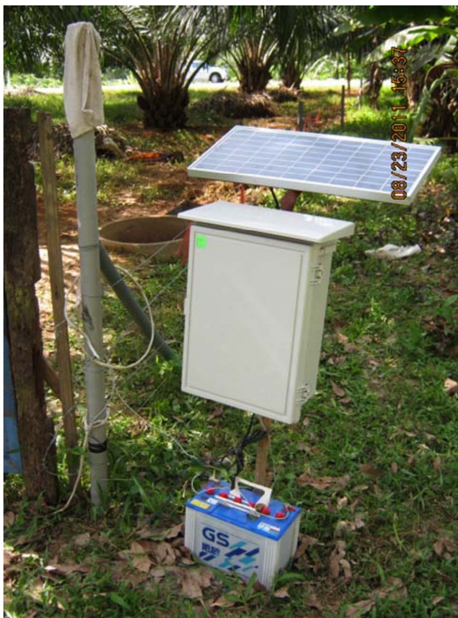
ภาพที่ 50 การทดสอบกรณีศึกษา เครื่องผลิตไฟฟ้าสร้างแบบยึดอุปกรณ์ไว้กับที่
