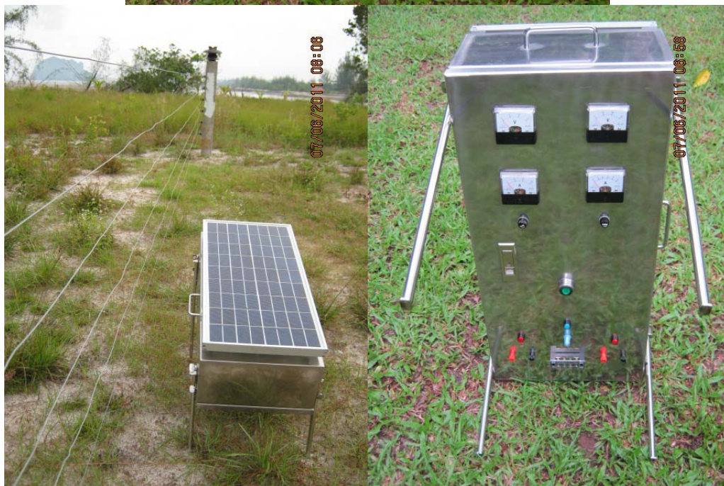
ภาพที่ 38 เครื่องผลิตไฟฟ้าแรงดันสูงกั้นบริเวณเลี้ยงสัตว์เคี้ยวเอื้อง
