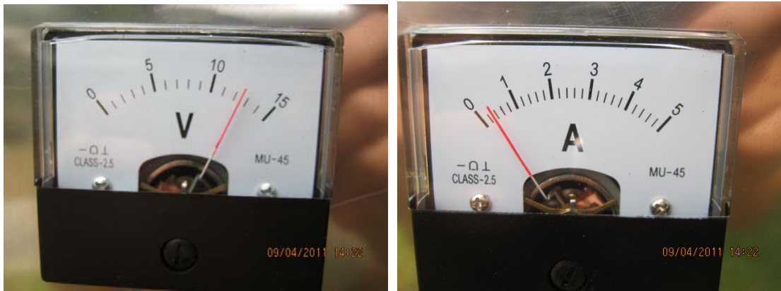
ภาพที่ 43 การทดสอบการทำงานของแบตเตอรี่ โวลต์ และ แอมแปร์
