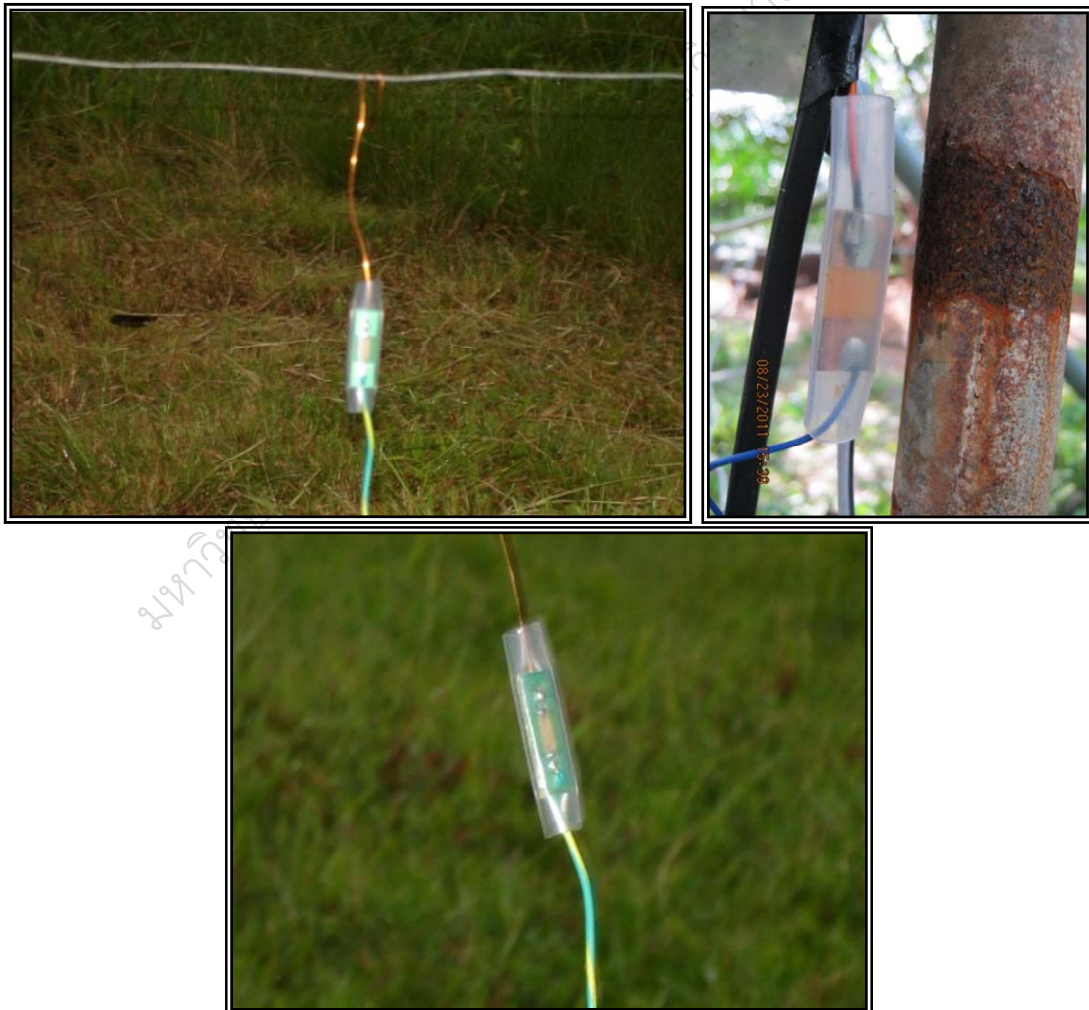
ภาพที่ 44 การทดสอบการเกิดประกายไฟของการสปาร์กลวดตัวนำ
