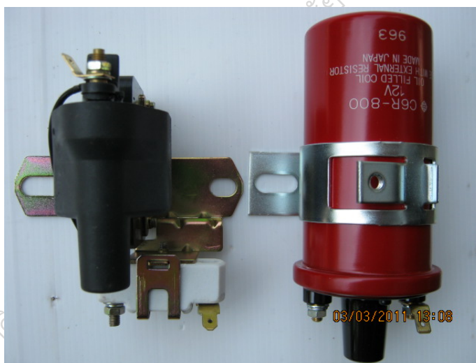
ภาพที่ 29 ลักษณะของคอยล์จุกระเบิดที่ใช้กับรถยนต์ทั่วไปนำมาใช้ในโครงการนี้
