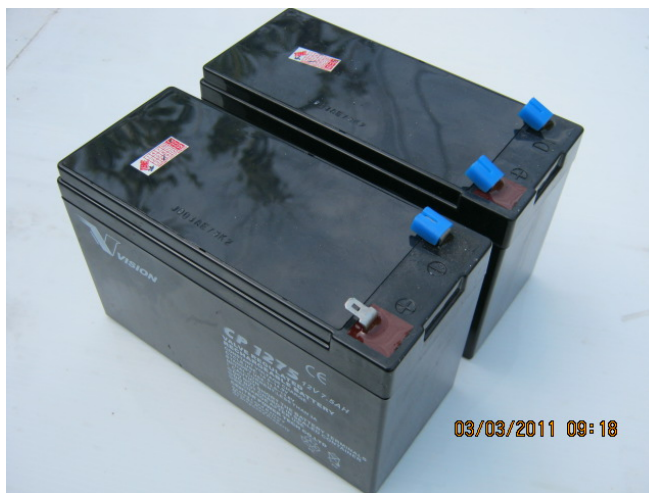
ภาพที่ 27 แบตเตอรี่ขนาด 12 โวลต์ 7.5 แอมป์ชั่วโมง
