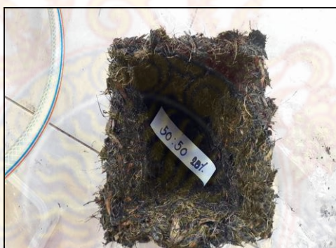
ภาพที่ 3.13 กระจางที่มีส่วนผสมเส้นใยปาล์มน้ำมันต่อกากตะกอนน้ำมันปาล์ม อัตราส่วน 50:50 และกาวแป้งเปียกที่ความเข้มข้นร้อยละ 20
