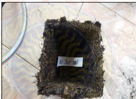
ภาพที่ 3.11 กระจางที่มีส่วนผสมเส้นใยปาล์มน้ำมันต่อกากตะกอนน้ำมันปาล์ม อัตราส่วน 50:50 และกาวแป้งเปียกที่ความเข้มข้นร้อยละ 10
