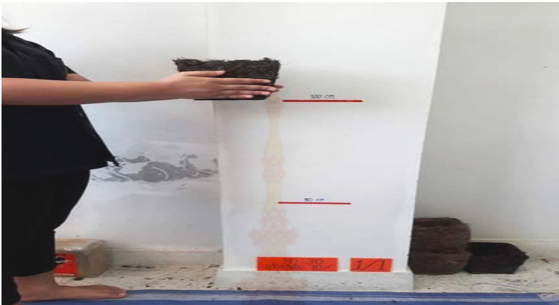
ภาพผนวกที่ ค3 ทดสอบความต้านทานการตกกระแทก ระดับ 100 เซนติเมตร
