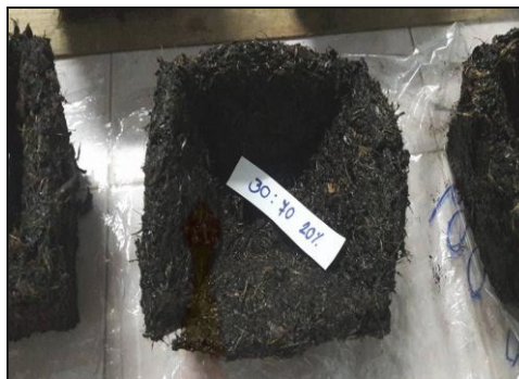
ภาพที่ 3.18 กระถางที่มีส่วนผสมเส้นใยปาล์มน้ำมันต่อกากตะกอนน้ำมันปาล์ม อัตราส่วน 30:70 และกาวแป้งเปียกที่ความเข้มข้นร้อยละ 20
