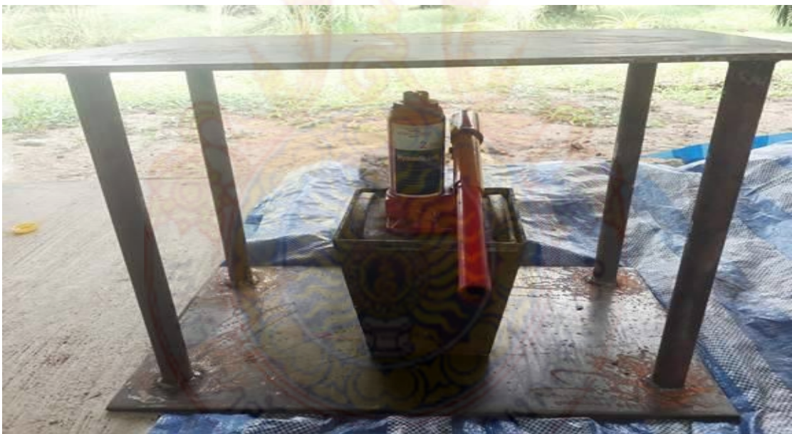
ภาพผนวกที่ ข4 แม่พิมพ์กระดาษพร้อมเครื่องกดอัดไฮโดรลิก
