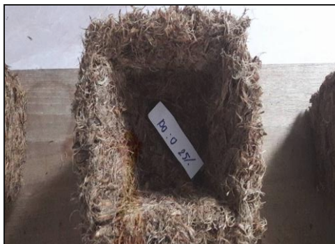
ภาพที่ 3.4 กระถางที่มีส่วนผสมเส้นใยปาล์มน้ำมันต่อกากตะกอนน้ำมันปาล์ม อัตราส่วน 100:0 และกาวแป้งเปียกที่ความเข้มข้นร้อยละ 25
