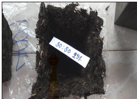
ภาพที่ 3.14 กระถางที่มีส่วนผสมเส้นใยปาล์มน้ำมันต่อกากตะกอนน้ำมันปาล์ม อัตราส่วน 50:50 และกาวแป้งเปียกที่ความเข้มข้นร้อยละ 25
