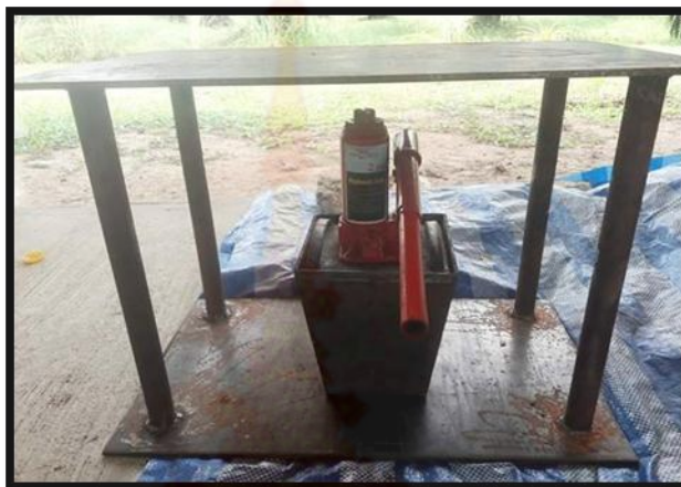
ภาพที่ 2.1 แม่พิมพ์กระถางพร้อมเครื่องกดอัดไฮโดรลิก
