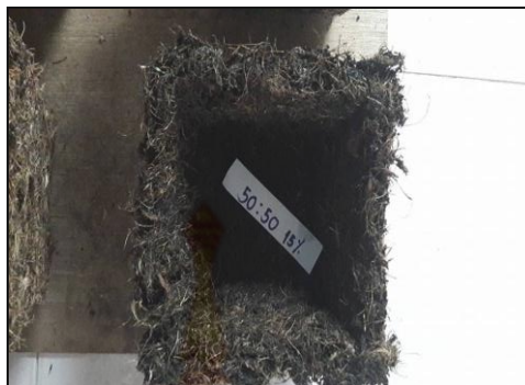
ภาพที่ 3.12 กระจางที่มีส่วนผสมเส้นใยปาล์มน้ำมันต่อกากตะกอนน้ำมันปาล์ม อัตราส่วน 50:50 และกาวแป้งเปียกที่ความเข้มข้นร้อยละ 15
