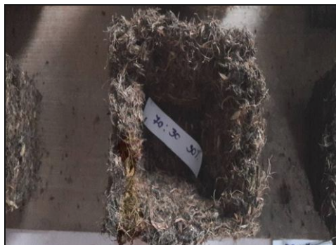
ภาพที่ 3.10 กระจางที่มีส่วนผสมเส้นใยปาล์มน้ำมันต่อกากตะกอนน้ำมันปาล์ม อัตราส่วน 70:30 และกาวแป้งเปียกที่ความเข้มข้นร้อยละ 30
