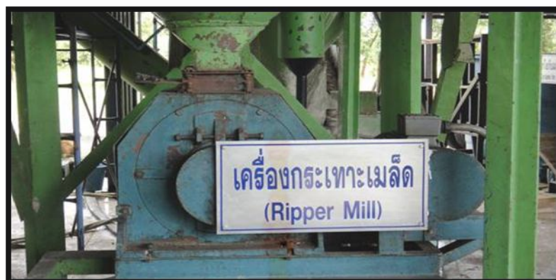
ภาพที่ 1.8 กระบวนการกระเทาะเมล็ดและแยกเส้นใย ที่มา: บริษัท พัทธ์กะปาล์มออยล์ จำกัด (2555)
