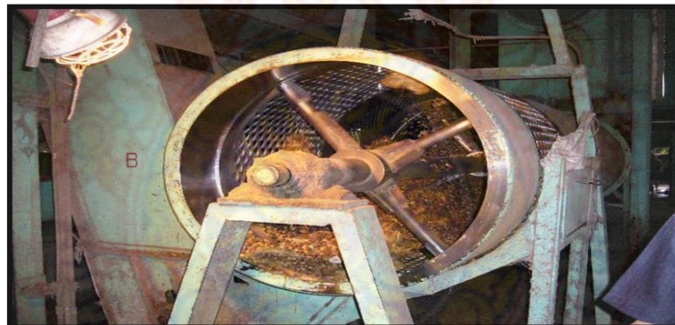
ภาพที่ 1.5 การบีบน้ำมันจากผลปาล์มดิบ ที่มา: บริษัท พัทพ์กษปาล์มออยล์ จำกัด (2555)
