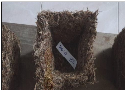
ภาพที่ 3.2 กระจางที่มีส่วนผสมเส้นใยปาล์มน้ำมันต่อกากตะกอนน้ำมันปาล์ม อัตราส่วน 100:0 และกาวแปงเปียกที่ความเข้มข้นร้อยละ 15
