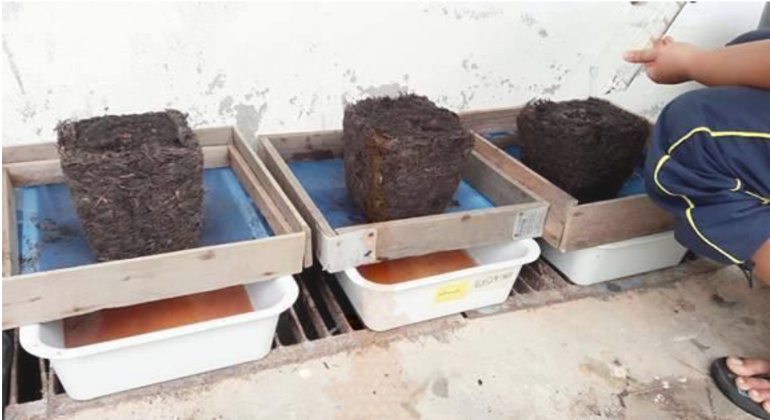
ภาพผนวกที่ ค5 ทดสอบการอุ้มน้ำของกระถาง
