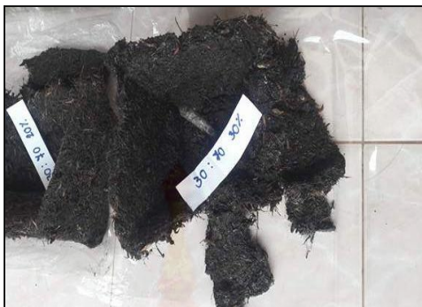
ภาพที่ 3.20 กระจกที่มีส่วนผสมเส้นใยปาล์มน้ำมันต่อกากตะกอนน้ำมันปาล์ม อัตราส่วน 30:70 และกาวแปงเปียกที่ความเข้มข้นร้อยละ 30
