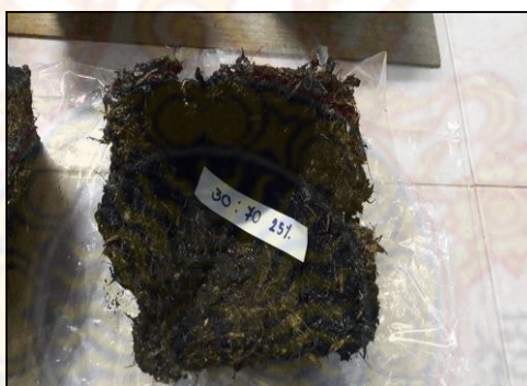
ภาพที่ 3.19 กระถางที่มีส่วนผสมเส้นใยปาล์มน้ำมันต่อกากตะกอนน้ำมันปาล์ม อัตราส่วน 30:70 และกาวแป้งเปียกที่ความเข้มข้นร้อยละ 25
