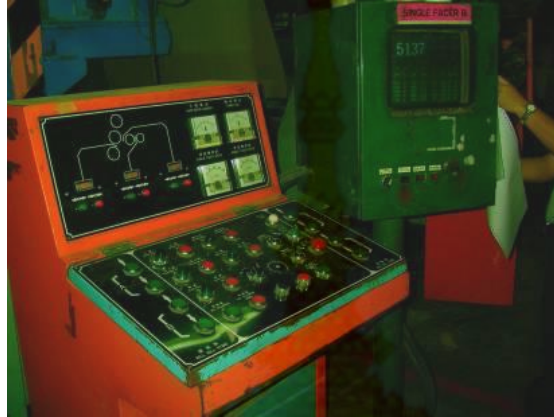
แผนภาพ 11 Corrugation : การทำลอนกระดาษลูกฟูก ด้วยเครื่องจักรอัตโนมัติ
