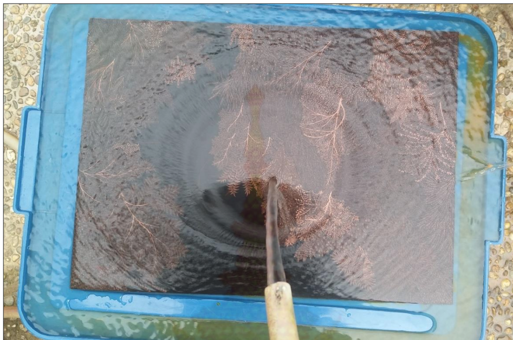
ภาพประกอบที่ 20 ภาพการนำแม่พิมพ์ไปล้างน้ำไหลเพื่อล้างกรด
