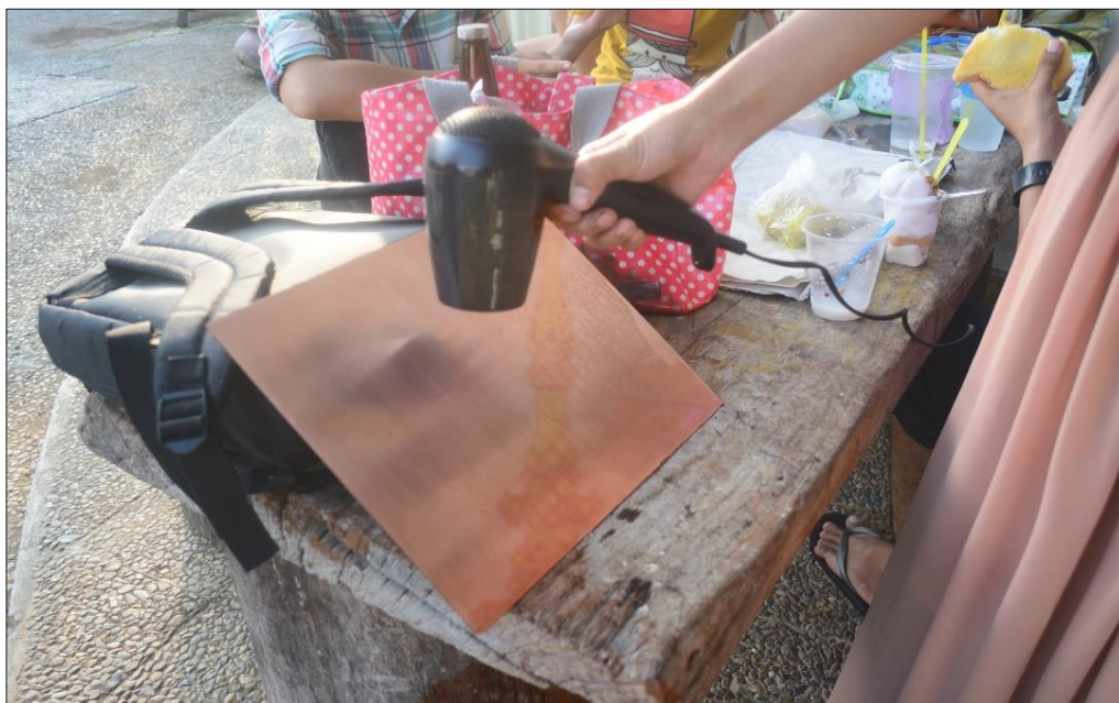
ภาพประกอบที่ 15 ภาพการใช้ไดร์เป่าแผ่นทองแดงที่ตัดแล้วให้แห้งสนิท
