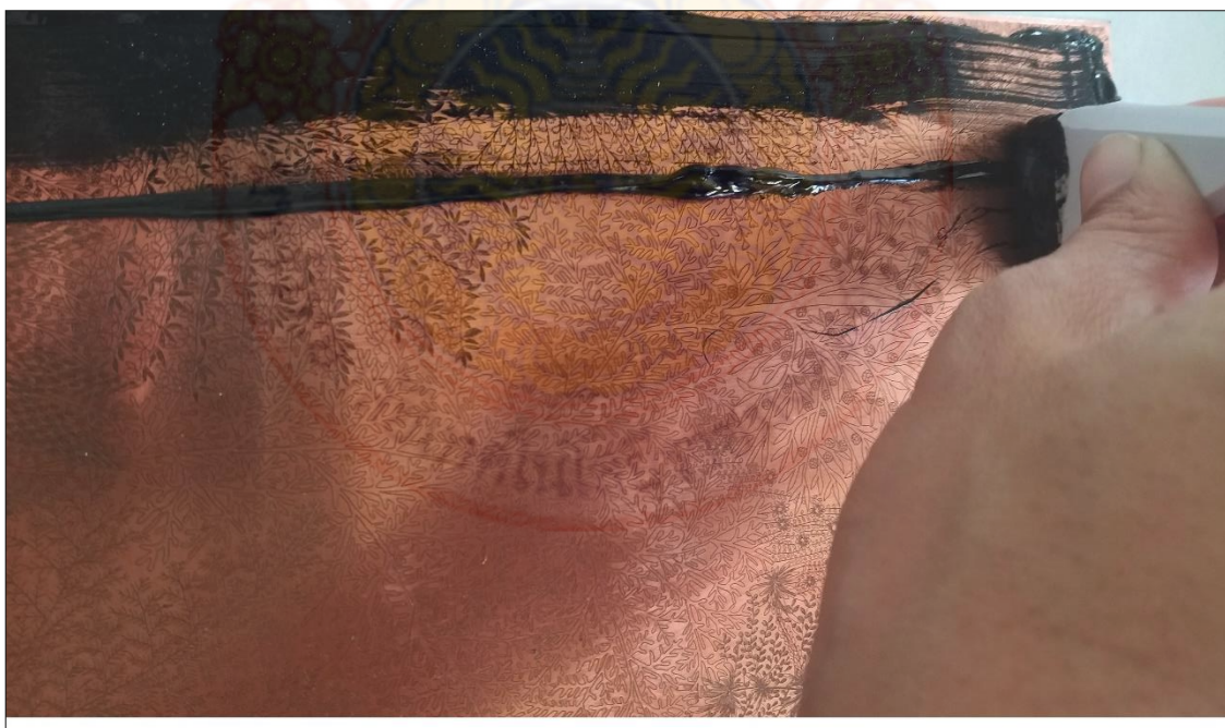
ภาพประกอบที่ 23 ภาพขั้นตอนการตักและปาดหมึกพิมพ์ลงบนแม่พิมพ์
