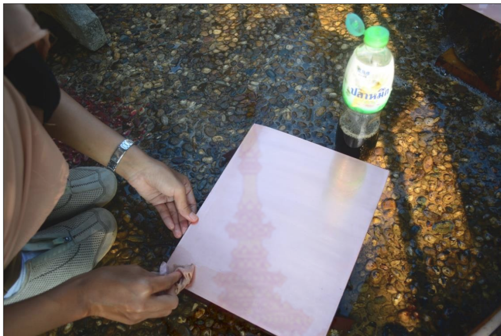
ภาพประกอบที่ 13 ภาพการเช็ดด้วยน้ำปลาโดยใช้ผ้าสะอาดจนแผ่นทองแดงเกลี้ยงที่สุด
