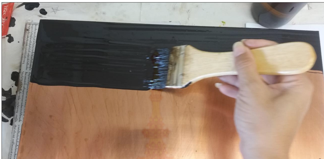
ภาพประกอบที่ 9 ภาพการนำวานิชที่ผสมแล้วทาลงบนแผ่นทองแดงโดยใช้แปรงทาไปทางเดียวกันให้มีความหนาเท่ากันทั้งแผ่น
