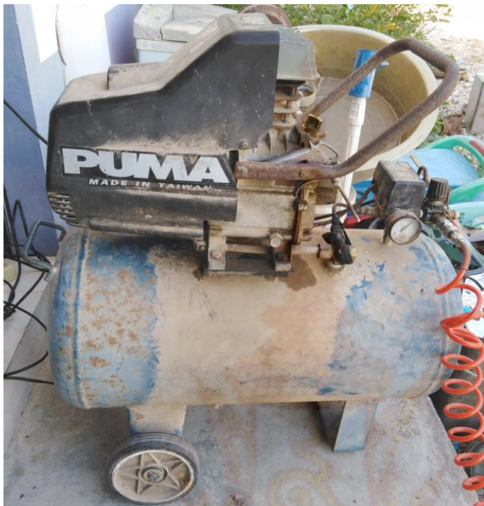
ภาพที่ 40 ภาพแสดงถังลม ใช้ในการสร้างแรงอัดลม
