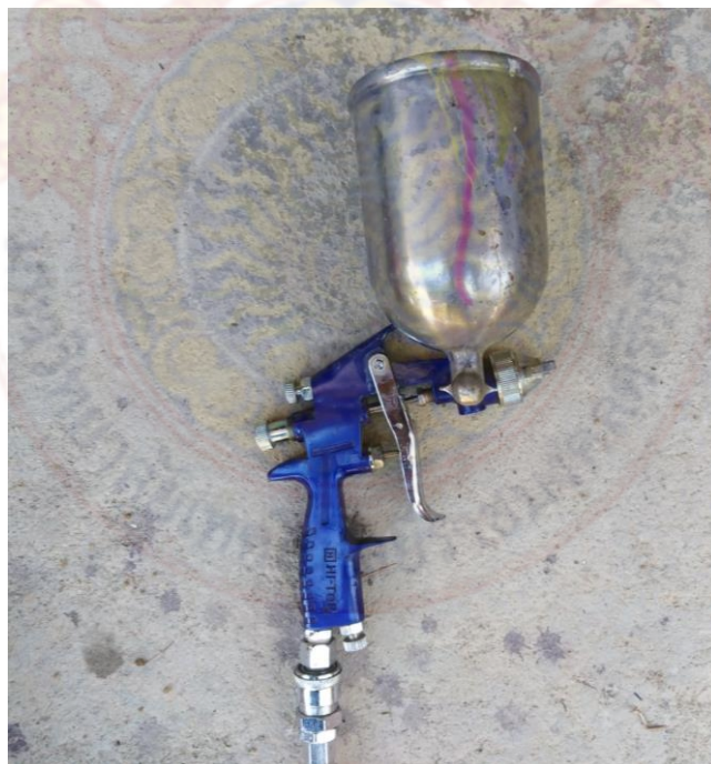
ภาพที่ 39 ภาพแสดงกาพ่นสี ใช้ในการสร้างน้ำหนักเบา พ่นสิ่งง่าย พ่นสีได้แม่นยำ สม่ำเสมอ ต่อเนื่อง และส่วนบริเวณที่กว้าง
