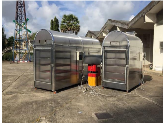
ภาพที่ 3 ระบบปั๊มความร้อนร่วมรังสีอาทิตย์แบบเรือนกระจก
